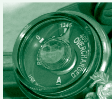
ตรวจสอบแรงดัน เข็มวัด ความดันต้องอยู่ในเขตสีเขียว
